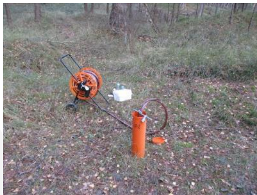
Pobór próbek wody podziemnej do badań jakościowych
